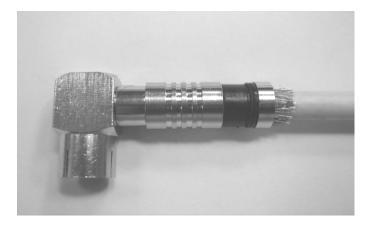
Mit der Kompressionzange **FWQ4** verpressen. Compress the plug with the compression tool **FWQ4**.
