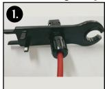
Stecken Sie den Solarstecker durch das mittlere Loch des Montageschlüssels.
